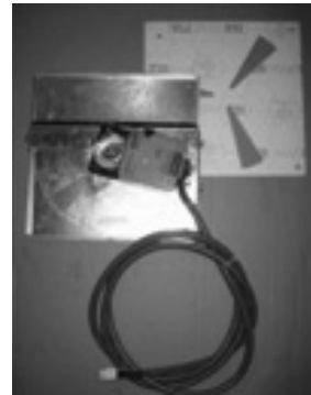
Sekundärluftklappe mit Dichtung!
